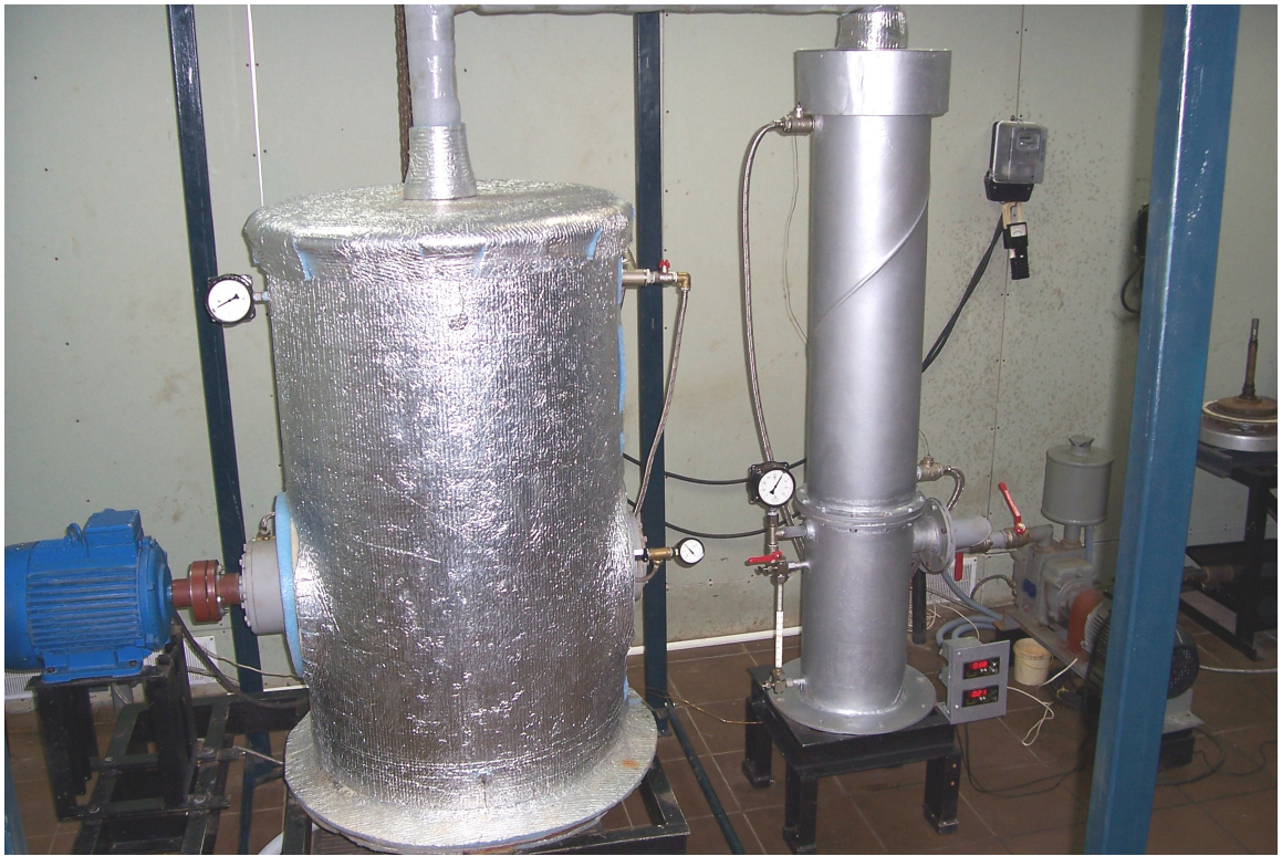
Рис. 1. Многоступенчатый роторный кавитационный теплогенератор, встроенный в емкость с нагреваемой жидкостью.
